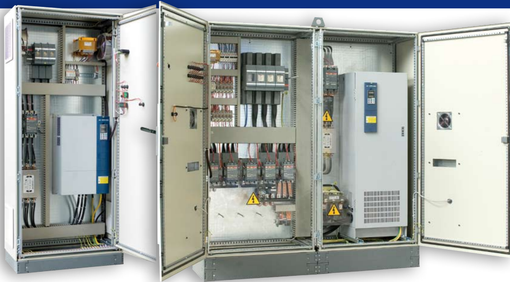
Quadro inverter Rimor 220Kw IP55 con by pass stella/triangolo per mescolatore Board for inverter by Rimor - 220kW IP55 - with bypass star/delta connection for mixer Die Tafel für den Inverter von Rimor - 220kW IP55 - mit dem Bypass Stern/Dreieck Schaltung für den Mischer
